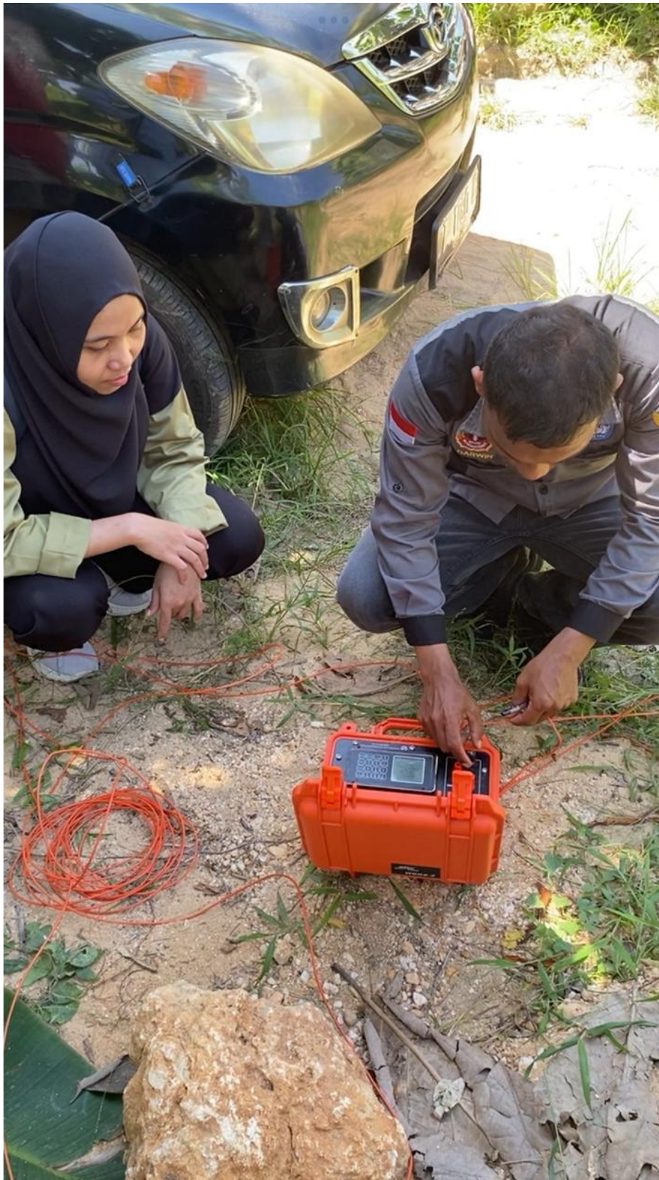
Gambar 9. Pemasangan Kabel ke Alat Geolistrik
