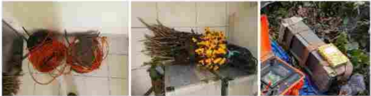
Foto 2. Alat Bantu Pengukuran Geolistrik
