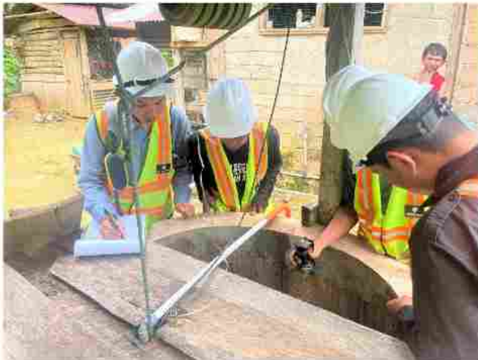
Gambar 5.8 Foto Pumping Test Pada CAT Tangketada
