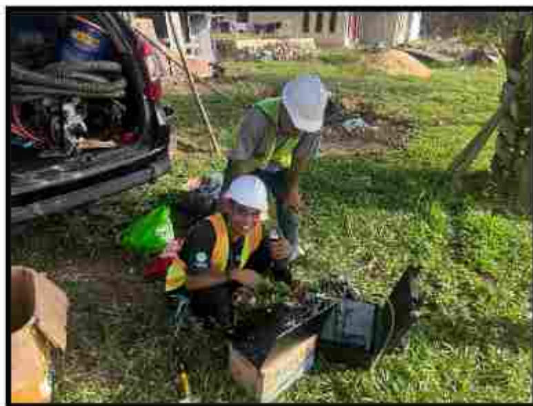
Gambar 5.25 Pengambilan data geolistrik pada lintasan GL-08
