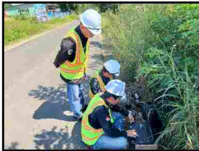
Gambar 5.17 Pengambilan data geolistrik pada lintasan GL-04
