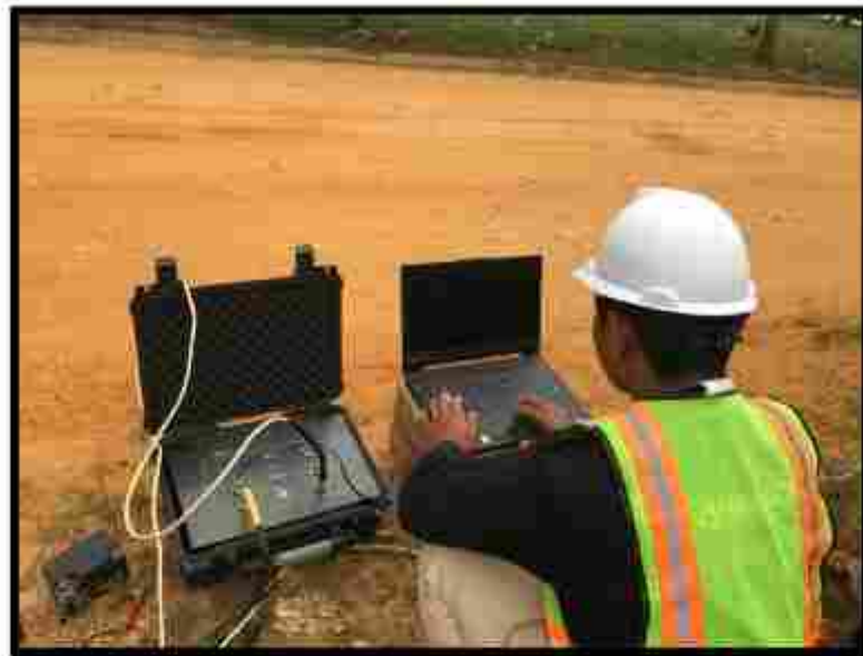
Gambar 5.13 Pengambilan data geolistrik pada lintasan GL-02
