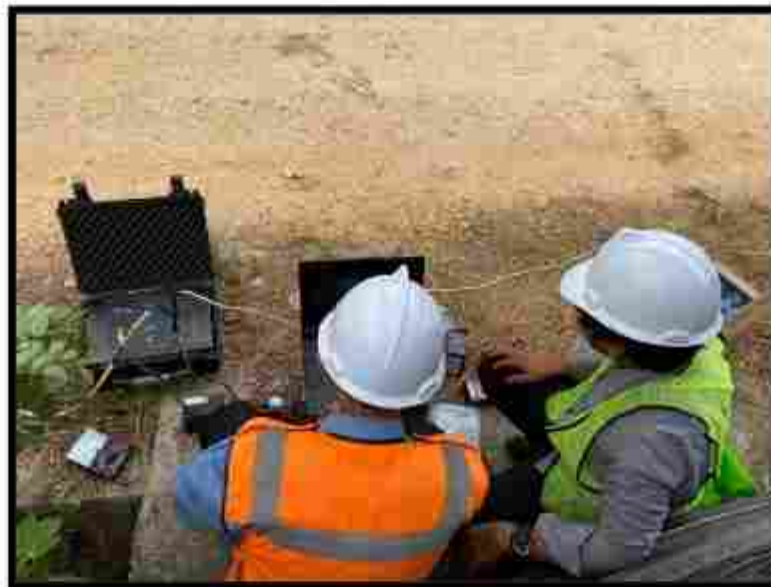
Gambar 5.23 Pengambilan data geolistrik pada lintasan GL-07
