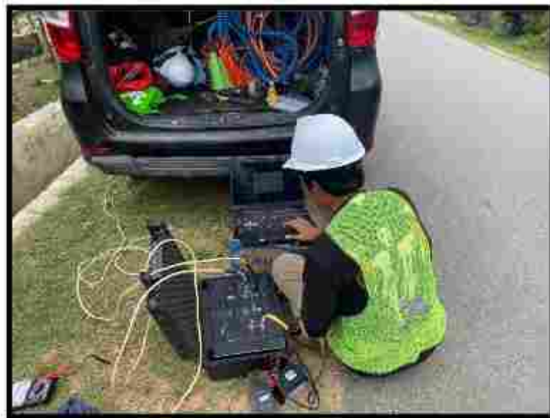
Gambar 5.19 Pengambilan data geolistrik pada lintasan GL-05
