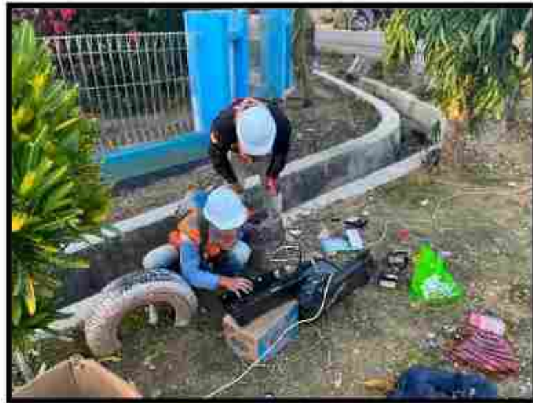
Gambar 5.11 Pengambilan data geolistrik pada lintasan GL-01
